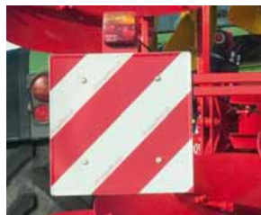
Panneaux de signalisation et éclairage
